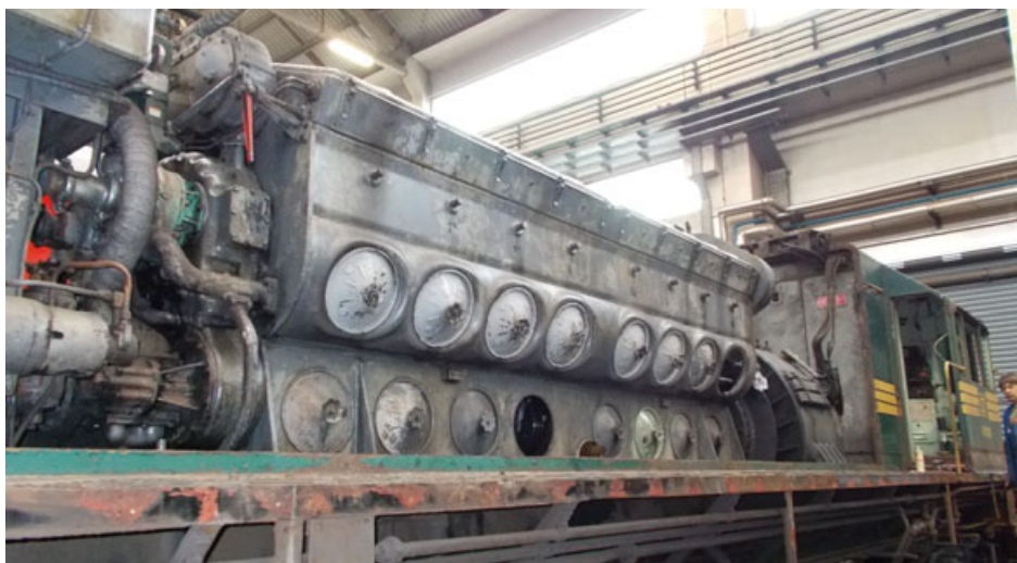
Motor pred izgradnjo, 16-567
